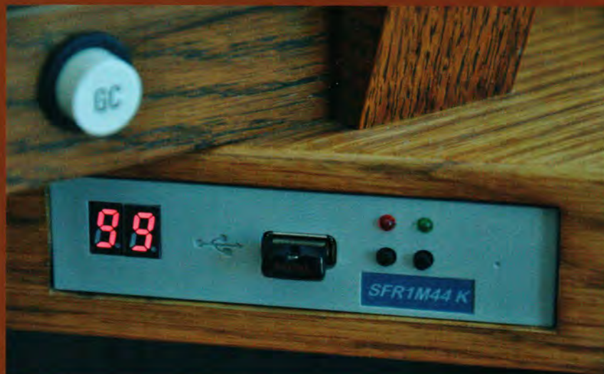
Das Diskettenlaufwerk wurde durch eine USB-Schnittstelle ersetzt (rechts).
